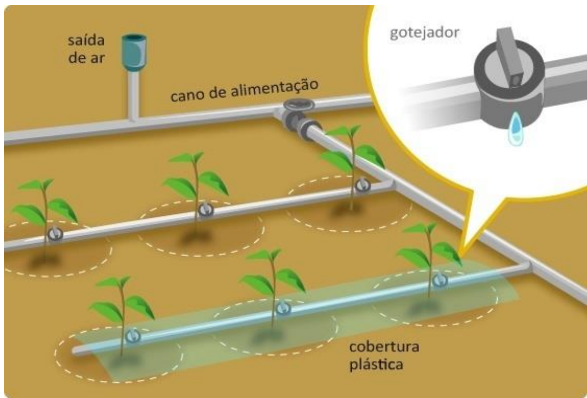
Figura 01: Modelo de um sistema de irrigação por gotejamento.
